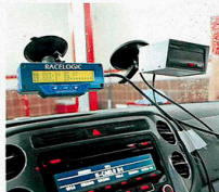
Для надежности результаты фиксировались дву-ми измерительными комплексами — один работал на основе высокоточного GPS-приемника, другой получал информацию от оптического датчика, за-крепленного на правой двери автомобиля
