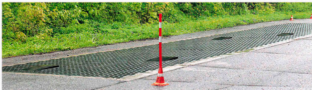
Расположенные в шахматном порядке трамплины имитируют неровности, особенно характерные для зимней дороги. Минув такой трамплин, колесо на время теряет контакт с опорной поверхностью
